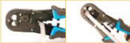
Corte de cables de red
