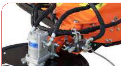
Pistón hidráulico de retroceso.
