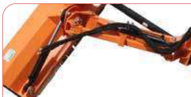
2 hidráulicos para giro lateral y eje.
