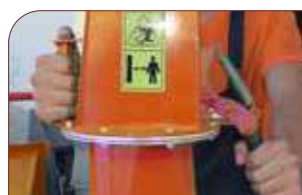
Chimenea de salida regulable 360°.
