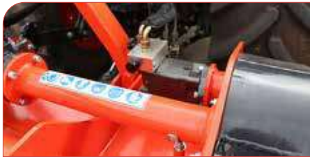
Motor hidráulico regulable.
