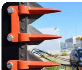
21 secciones dentadas y dobles dedos.
