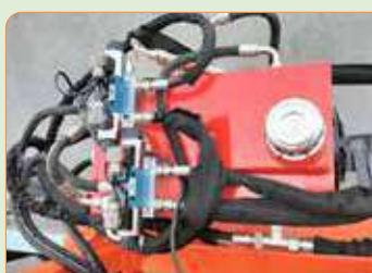
2 electroválvulas de doble efecto y depósito de aceite 45L.
