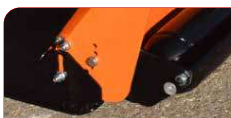
Patines ajustables en altura. Rodillo.
