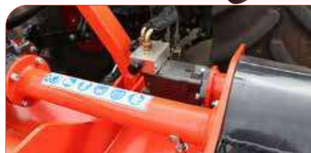
Motor hidráulico regulable.
