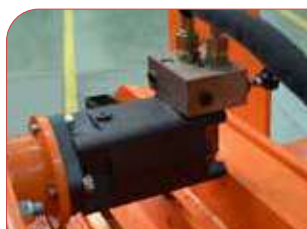
Motor hidráulico regulable del rodillo alimentador.
