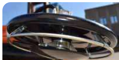
Disco desbrozador con dos cuchillas
