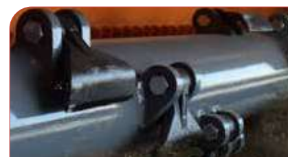
Martillos sobre eje de 168 mm.
