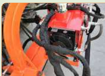
Radiador con termostato.
