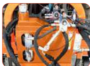
Detalle Grupo Hidráulico
