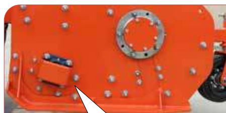
Motor hidráulico regulable.
