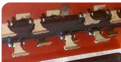
Martillos y eje de 170 mm.
