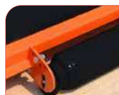
Rodillo ajustable. 3 posiciones.
