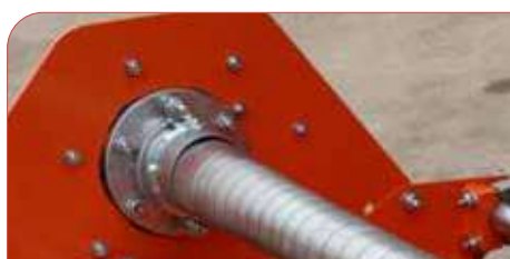
Eje de transmisión desplazable.
