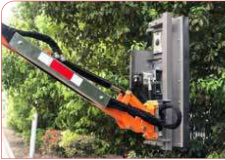
Barra de cuchillas con motor hidráulico.
