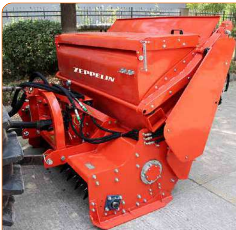
Modelo ZEPPELIN TOP VIÑA con tolva de elevación y volteo telescópico.
