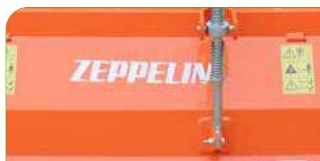
Portón ajustable con amortiguador.
