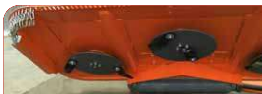
3 Discos de 2 cuchillas: Espesor 8 mm. Longitud 107 mm. Anchura 60 mm.
